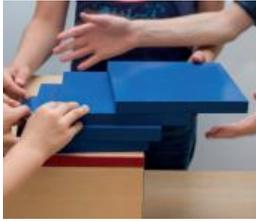
Bei diesem Experiment kommt es darauf an, Steine so auf ein Podest aufzutürmen, dass ein Stein frei über dem Abgrund schwebt.
